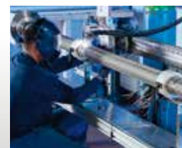
En la producción de filtros, PACO utiliza equipos de soldadura de fabricación propia – por ejemplo para la producción de elementos filtrantes extra largos (hasta 4.200 mm).
