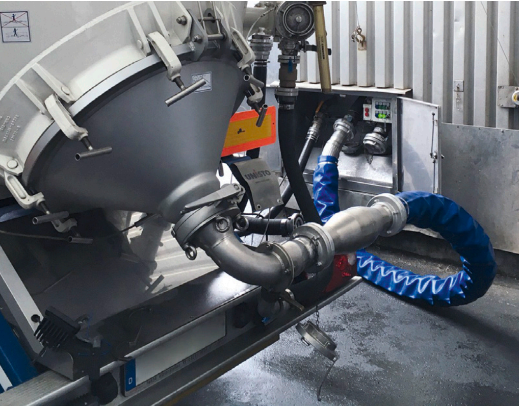
Der neue Polzeifilter von Paco separiert Fremdkörper aus dem Produktstrom während der Zuckeranlieferung bei Ritter. Ein Magnetabscheider sorgt für die Entfernung von Eisenpartikeln.
